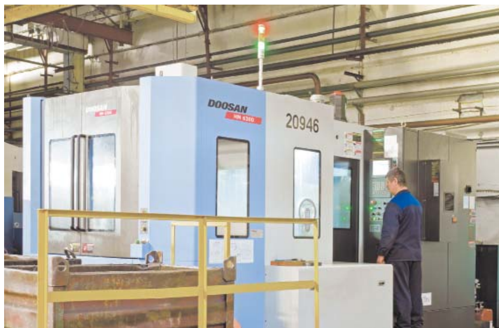
DOOSAN 6300HM заменил 4 станка и филигранно точно обрабатывает балансиры и звенья гусениц
