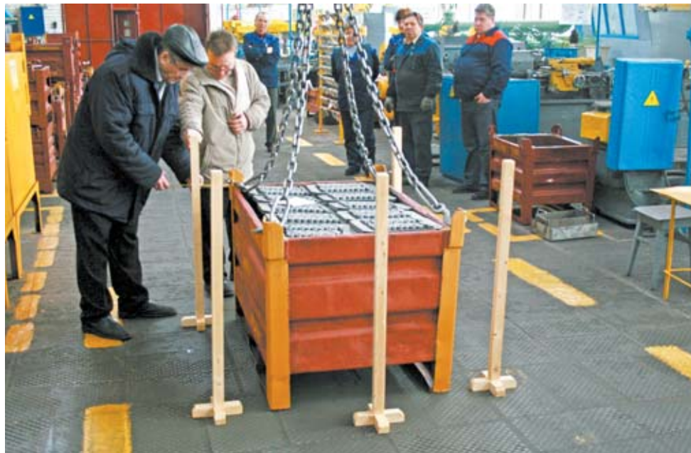
Крановщицы заводят многотонный груз в «гараж» из пяти стоек
